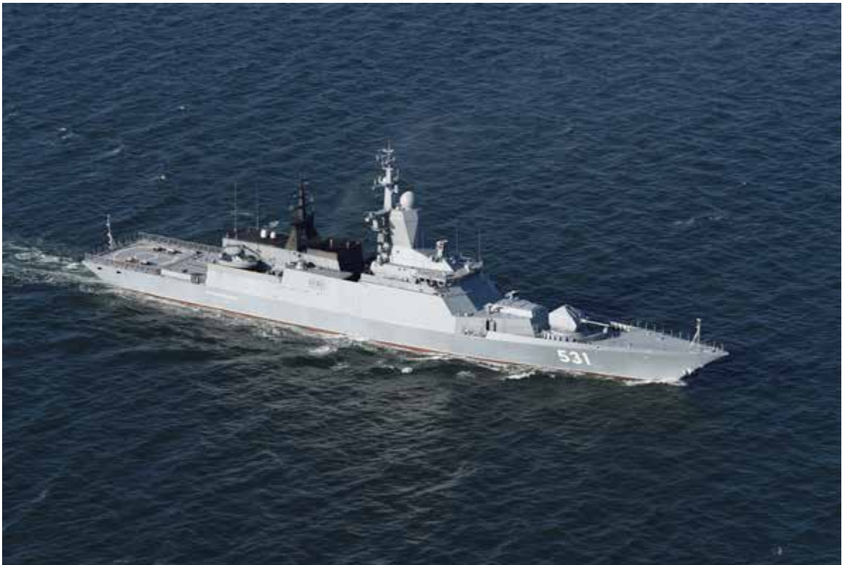
En af Østersøflådens fire korvetter af Steregushchiy-klassen med øvelsesminer på agterdækket. Skibet er fotograferet i forbindelse med udpassage gennem dansk farvand. Foto: Flyvevåbnets Fototjeneste.
